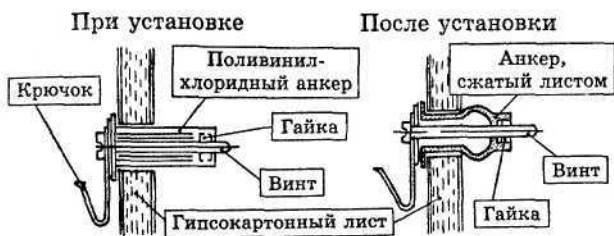
Рис. 21. Крючки для крепления в гипсокартонных перегородках
